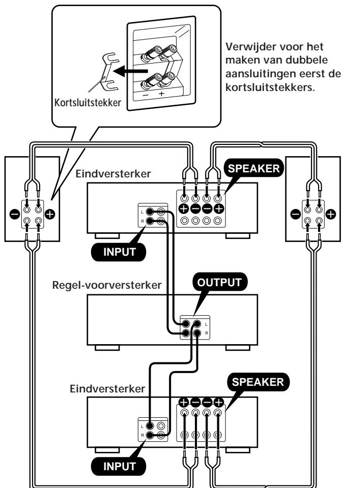
Verbind bij alle snoeren de gemaakte snoerader (met een streepje, een opschrift e.d.) met de "+" aansluitingen.
